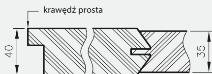
Przekrój poziomy drzwi Elsa
